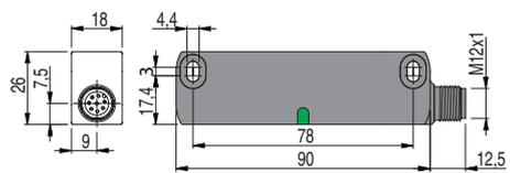
Sensore ST G••••M0.2 con cavo e connettore M12
