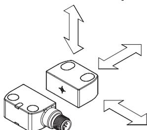
I sensori sono stati studiati per poter essere azionati da più direzioni, permettendo così al cliente la massima flessibilità nel posizionamento dei dispositivi lungo i perimetri delle protezioni.
