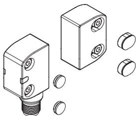
Ogni sensore ed azionatore viene fornito completo di tappi di protezione ad incastro da applicare sui fori delle viti di fissaggio. Questi tappi, oltre a prevenire l'accumulo di sedimenti e facilitare la pulizia, precludono l'accesso alle viti di fissaggio dell'azionatore. Pertanto si possono utilizzare viti standard al posto delle viti antieffrazione.
