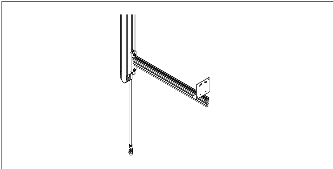
Abb.: PSEN opII muting arm am Sicherheitslichtgitter montiert und PSEN opII muting arm bracket kit nach oben ausgerichtet
