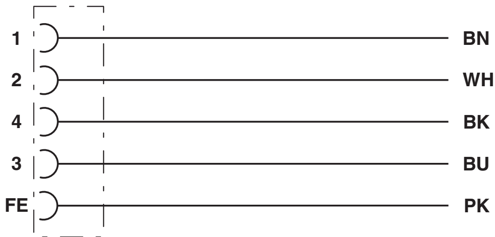
Equipaggiamento dei contatti del connettore femmina M12
