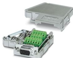
Connettore femmina D-SUB, 15 poli, due ingressi cavi a 35°, tipo universale per tutti i sistemi, piedinatura: 1, 2, 3, ..., 14, 15 su morsetto a vite
