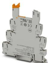
Morsetto base PLC da 6,2 mm, contro correnti e/o tensioni di disturbo sul lato di comando con connessione a vite, senza equipagg. relè o relè a stato solido, per il montaggio su guida di montaggio, NS 35/7,5, con filtro RCZ integrato, 1 contatti di scambio tens. di ingr.: 120 V DC
