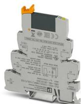
PLC-INTERFACE, composta da morsetto base montabile su guida di montaggio con connessione a vite e relè a stato solido in miniatura a innesto, ingresso: 120 V AC/110 V DC, uscita: 3-48 V DC/100 mA, UL/cUL: omologata per l'uso in zona Ex classe I, div. 2
