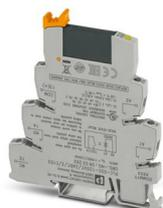
PLC-INTERFACE, composta da morsetto base montabile su guida di montaggio con connessione a vite e relè a stato solido in miniatura a innesto, ingresso: 120 V AC/110 V DC, uscita: 3-33 V DC/3 A, UL/cUL: omologata per l'uso in zona Ex classe I, div. 2
