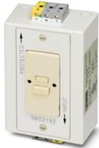
Presa di corrente, tipo di connessione: Connessione a vite, colore: avorio, tensione nominale: 125 V AC, corrente nominale: 20 A, norme/disposizioni: UL 508, CSA 22.2
