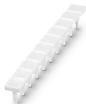
Nastro Zack per chiodini di siglatura, Striscia, bianco, in bianco, siglabile con: CMS-P1-PLOTTER, tipo di montaggio: Innesto, per morsetti con spessore: 5 mm, Numero dei cartellini singoli: 1000, altezza del campo di testo: 4 mm, larghezza del campo di testo: 4 mm
