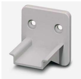
Supporto angolare di plastica, con profilo per guide di supporto NS 35/7,5, per l'inserimento a scatto di morsetti componibili con piedino universale, lunghezza del profilato: 35 mm
