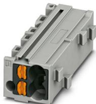
Blocco di ripartizione, tensione nominale: 500 V, corrente nominale: 17,5 A, tipo di connessione: Connessione Push-in, sezione: 0,14 mm<sup>2</sup> - 2,5 mm<sup>2</sup>, montaggio: montaggio su adattatori per il fissaggio su guida di supporto, montaggio su flangia di copertura, colore: grigio, elementi di connessione colore: nero
