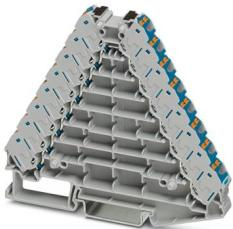
Ripartitore di potenziale, tensione nominale: 250 V, corrente nominale: 17,5 A, tipo di connessione: Connessione Push-in, 1., 2., 3., 4., 5., 6., 7. e 8. piano, Sezione di dimensionamento: 1,5 mm<sup>2</sup>, sezione: 0,14 mm<sup>2</sup> - 2,5 mm<sup>2</sup>, montaggio: NS 35/7,5, NS 35/15, colore: grigio, elementi di connessione colore: blu
