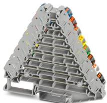
Ripartitore modulare, tensione nominale: 250 V, corrente nominale: 8 A, tipo di connessione: Connessione Push-in, 1., 2., 3., 4., 5., 6., 7. e 8. piano, Sezione di dimensionamento: 1,5 mm<sup>2</sup>, sezione: 0,14 mm<sup>2</sup> - 2,5 mm<sup>2</sup>, montaggio: NS 35/7,5, NS 35/15, colore: grigio
