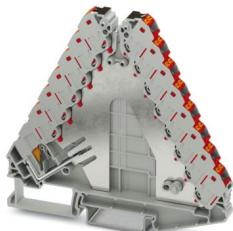
Ripartitore di potenziale, Con possibilità di alimentazione fino a 6 mm<sup>2</sup>, tensione nominale: 250 V, corrente nominale: 17,5 A, tipo di connessione: Connessione Push-in, Sezione di dimensionamento: 1,5 mm<sup>2</sup>, sezione: 0,14 mm<sup>2</sup> - 2,5 mm<sup>2</sup>, Piano di alimentazione, Sezione di dimensionamento: 4 mm<sup>2</sup>, sezione: 0,2 mm<sup>2</sup> - 6 mm<sup>2</sup>, montaggio: NS 35/7,5, NS 35/15, colore: grigio, elementi di connessione colore: rosso
