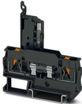
Morsetto portafusibili, tipo di fusibile: Vetro / ceramica / ..., tipo fusibile: G / 5 x 20, tensione nominale: 500 V, corrente nominale: 6,3 A, tipo di connessione: Connessione Push-in, 1. piano, Sezione di dimensionamento: 1 mm<sup>2</sup>, sezione: 0,2 mm<sup>2</sup>- 6 mm<sup>2</sup>, tipo di montaggio: NS 35/7,5, NS 35/15, colore: nero
