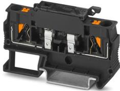
Morsetto portafusibili, tipo di fusibile: Vetro / ceramica / ..., tipo fusibile: G / 5 x 20, tensione nominale: 250 V, corrente nominale: 6,3 A, tipo di connessione: Connessione Push-in, 1. piano, Sezione di dimensionamento: 1 mm<sup>2</sup>, sezione: 0,2 mm<sup>2</sup>- 6 mm<sup>2</sup>, tipo di montaggio: NS 35/7,5, NS 35/15, colore: nero
