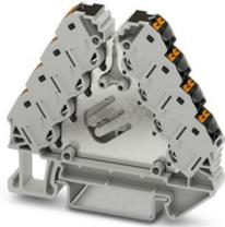
Ripartitore di potenziale, tensione nominale: 250 V, corrente nominale: 17,5 A, tipo di connessione: Connessione Push-in, 1., 2., 3. e 4. piano, Sezione di dimensionamento: 1,5 mm<sup>2</sup>, sezione: 0,14 mm<sup>2</sup> - 2,5 mm<sup>2</sup>, montaggio: NS 35/7,5, NS 35/15, colore: grigio, elementi di connessione colore: nero
