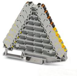
Ripartitore di potenziale, tensione nominale: 250 V, corrente nominale: 17,5 A, tipo di connessione: Connessione Push-in, 1., 2., 3., 4., 5., 6., 7. e 8. piano, Sezione di dimensionamento: 1,5 mm<sup>2</sup>, sezione: 0,14 mm<sup>2</sup> - 2,5 mm<sup>2</sup>, montaggio: NS 35/7,5, NS 35/15, colore: grigio, elementi di connessione colore: nero, giallo
