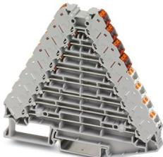
Ripartitore modulare, tensione nominale: 250 V, corrente nominale: 8 A, tipo di connessione: Connessione Push-in, 1., 2., 3., 4., 5., 6., 7. e 8. piano, Sezione di dimensionamento: 1,5 mm<sup>2</sup>, sezione: 0,14 mm<sup>2</sup> - 2,5 mm<sup>2</sup>, montaggio: NS 35/7,5, NS 35/15, colore: grigio, elementi di connessione colore: rosso, bianco
