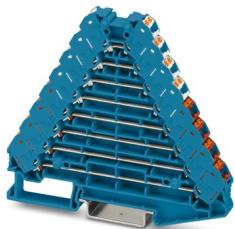
Ripartitore modulare, tensione nominale: 250 V, corrente nominale: 8 A, tipo di connessione: Connessione Push-in, 1., 2., 3., 4., 5., 6., 7. e 8. piano, Sezione di dimensionamento: 1,5 mm<sup>2</sup>, sezione: 0,14 mm<sup>2</sup> - 2,5 mm<sup>2</sup>, montaggio: NS 35/7,5, NS 35/15, colore: blu, elementi di connessione colore: bianco, rosso
