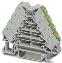
Ripartitore modulare, tensione nominale: 250 V, corrente nominale: 10 A, tipo di connessione: Connessione Push-in, 1., 2., 3. e 4. piano, Sezione di dimensionamento: 1,5 mm<sup>2</sup>, sezione: 0,14 mm<sup>2</sup> - 2,5 mm<sup>2</sup>, montaggio: NS 35/7,5, NS 35/15, colore: grigio, elementi di connessione colore: verde
