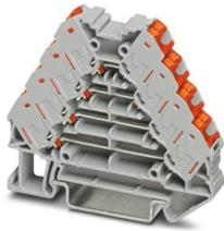
Ripartitore modulare, tensione nominale: 250 V, corrente nominale: 10 A, tipo di connessione: Connessione Push-in, 1., 2., 3. e 4. piano, Sezione di dimensionamento: 1,5 mm<sup>2</sup>, sezione: 0,14 mm<sup>2</sup> - 2,5 mm<sup>2</sup>, montaggio: NS 35/7,5, NS 35/15, colore: grigio, elementi di connessione colore: rosso
