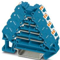
Ripartitore modulare, tensione nominale: 250 V, corrente nominale: 10 A, tipo di connessione: Connessione Push-in, 1., 2., 3. e 4. piano, Sezione di dimensionamento: 1,5 mm<sup>2</sup>, sezione: 0,14 mm<sup>2</sup> - 2,5 mm<sup>2</sup>, montaggio: NS 35/7,5, NS 35/15, colore: blu, elementi di connessione colore: bianco
