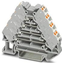
Ripartitore modulare, tensione nominale: 250 V, corrente nominale: 10 A, tipo di connessione: Connessione Push-in, 1., 2., 3. e 4. piano, Sezione di dimensionamento: 1,5 mm<sup>2</sup>, sezione: 0,14 mm<sup>2</sup> - 2,5 mm<sup>2</sup>, montaggio: NS 35/7,5, NS 35/15, colore: grigio, elementi di connessione colore: bianco
