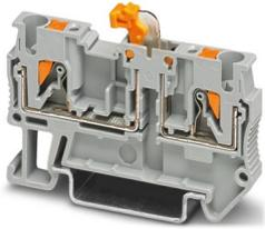
Morsetto con sezionatore a coltello, tensione nominale: 400 V, corrente nominale: 20 A, 1. piano, tipo di connessione: Connessione Push-in, Sezione di dimensionamento: 2,5 mm<sup>2</sup>, sezione: 0,14 mm<sup>2</sup> - 4 mm<sup>2</sup>, montaggio: NS 35/7,5, NS 35/15, colore: grigio
