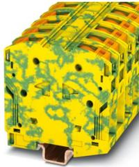
Morsetti comp. per conduttori terra, numero di connessioni: 2, numero poli: 1, tipo di connessione: Connessione PowerTurn, 1. piano, sezione: 10 mm<sup>2</sup> - 70 mm<sup>2</sup>, tipo di montaggio: NS 35/15, colore: giallo-verde
