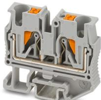
Minimorsetto passante, tensione nominale: 500 V, corrente nominale: 32 A, numero poli: 1, tipo di connessione: Connessione Push-in, Sezione di dimensionamento: 4 mm<sup>2</sup>, sezione: 0,2 mm<sup>2</sup> - 6 mm<sup>2</sup>, tipo di montaggio: NS 15, colore: grigio
