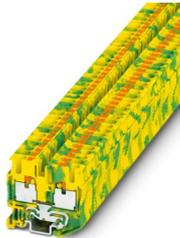
Morsetto per conduttori di terra mini, numero di connessioni: 2, tipo di connessione: Connessione Push-in, 1. piano, Sezione di dimensionamento: 2,5 mm<sup>2</sup>, sezione: 0,14 mm<sup>2</sup> - 4 mm<sup>2</sup>, tipo di montaggio: NS 15, colore: giallo-verde
