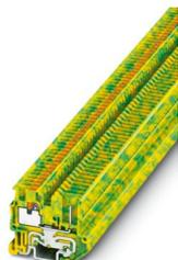
Morsetto per conduttori di terra mini, numero di connessioni: 2, tipo di connessione: Connessione Push-in, 1. piano, sezione: 0,14 mm<sup>2</sup> - 1,5 mm<sup>2</sup>, tipo di montaggio: NS 15, colore: giallo-verde
