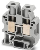
Minimorsetto passante, tensione nominale: 500 V, corrente nominale: 41 A, numero di connessioni: 2, numero poli: 1, tipo di connessione: Connessione a vite, Sezione di dimensionamento: 6 mm<sup>2</sup>, sezione: 0,2 mm<sup>2</sup> - 10 mm<sup>2</sup>, tipo di montaggio: NS 15, colore: grigio
