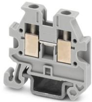
Minimorsetto passante, tensione nominale: 400 V, corrente nominale: 17,5 A, numero di connessioni: 2, numero poli: 1, tipo di connessione: Connessione a vite, Sezione di dimensionamento: 1,5 mm<sup>2</sup>, sezione: 0,14 mm<sup>2</sup> - 1,5 mm<sup>2</sup>, tipo di montaggio: NS 15, colore: grigio
