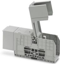
Morsetto di collegamento a bullone, tensione nominale: 1500 V, corrente nominale: 415 A, numero di connessioni: 2, numero poli: 1, tipo di connessione: Bullone, Sezione di dimensionamento: 240 mm<sup>2</sup>, tipo di montaggio: NS 35/7,5, NS 35/15, avvitamento diretto, colore: grigio
