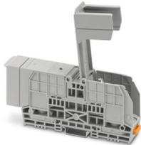
Morsetto di collegamento a bullone, tensione nominale: 1500 V, corrente nominale: 192 A, numero di connessioni: 2, numero poli: 1, tipo di connessione: Bullone, Sezione di dimensionamento: 70 mm<sup>2</sup>, tipo di montaggio: NS 35/7,5, NS 35/15, avvitamento diretto, colore: grigio
