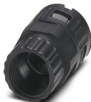
Adattatore per tubi ondulati, con filettatura interna, per la connessione di tubi ondulati a connessioni a vite in plastica HEAVYCON EVO M25 o custodie in plastica ADVANCE M25, diritto, nero, IP66.
