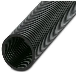
Guaina di protezione, materiale: PA 6, resistente ai raggi UV: sì, flessibile, grado di protezione: IP68, colore: nero, classe di infiammabilità secondo UL 94: V0, diametro interno: 36 mm, Lunghezza totale: 25 m
