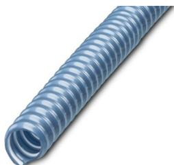
Guaina di protezione, materiale: PU, spirale: PUR Molla d'acciaio rivestita, resistente ai raggi UV: no, flessibile, grado di protezione: IP68, colore: blu, classe di infiammabilità secondo UL 94: V2, diametro interno: 22 mm, Lunghezza totale: 10 m
