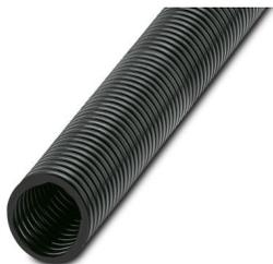
Guaina di protezione, materiale: PA 6, resistente ai raggi UV: sì, flessibile, grado di protezione: IP68, colore: nero, classe di infiammabilità secondo UL 94: V0, diametro interno: 23 mm, Lunghezza totale: 50 m
