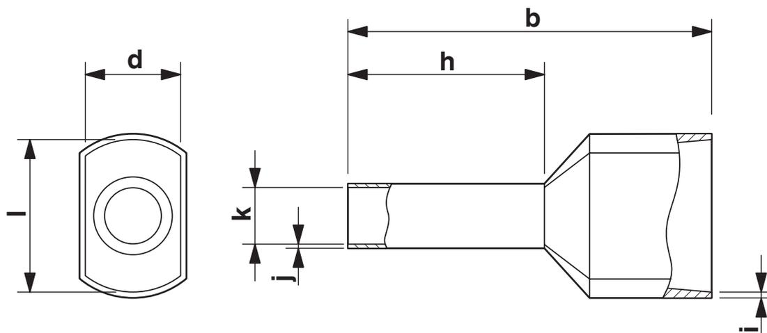
Lunghezza del manicotto (b), lunghezza dell'area di contatto (h) misura interna del collare di isolamento (d), diametro del manicotto (k), spessore del collare di isolamento (i), spessore della parete del manicotto (j)
