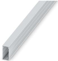
Canale di cablaggio per l'installazione e il montaggio in quadri elettrici, grigio chiaro, privo di alogenati, composto da parte superiore e parte inferiore, larghezza: 40 mm, altezza: 80 mm, lunghezza: 2000 mm
