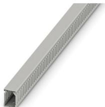
Canale di cablaggio per l'installazione e il montaggio in quadri elettrici, grigio, composto da parte superiore e parte inferiore, larghezza: 30 mm, altezza: 40 mm, lunghezza 2000 mm
