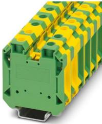
Morsetti comp. per conduttori terra, con piedino a vite, numero di connessioni: 2, tipo di connessione: Connessione a vite, Sezione di dimensionamento: 35 mm<sup>2</sup>, sezione: 1,5 mm<sup>2</sup> - 35 mm<sup>2</sup>, tipo di fissaggio: Piedino PE con vite di fissaggio M5, tipo di montaggio: NS 35/7,5, NS 35/15, colore: giallo-verde
