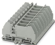
Morsetto sezionatore per conv. misura, tensione nominale: 800 V, corrente nominale: 57 A, tipo di connessione: Bullone, Sezione di dimensionamento: 10 mm<sup>2</sup>, colore: grigio
