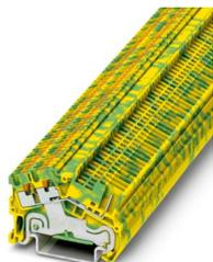
Morsetti comp. per conduttori terra, numero di connessioni: 3, numero poli: 1, tipo di connessione: Push-in / attacco connettore, 1. piano, sezione: 0,14 mm<sup>2</sup> - 1,5 mm<sup>2</sup>, tipo di montaggio: NS 35/7,5, NS 35/15, colore: giallo-verde
