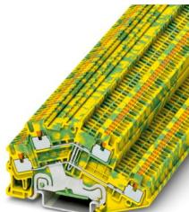
Morsetto a due piani per conduttori di terra, tipo di connessione: Connessione Push-in, 1. e 2. piano, sezione: 0,14 mm<sup>2</sup> - 1,5 mm<sup>2</sup>, tipo di montaggio: NS 35/7,5, NS 35/15, colore: giallo-verde
