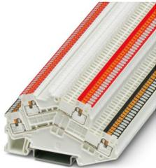
Morsetto a due piani, per bus KNX nell'installazione in edifici, tensione nominale: 500 V, corrente nominale: 16 A, tipo di connessione: Connessione Push-in, 1. e 2. piano, Sezione di dimensionamento: 1,5 mm<sup>2</sup>, sezione: 0,14 mm<sup>2</sup> - 1,5 mm<sup>2</sup>, tipo di montaggio: NS 35/7,5, NS 35/15, colore: bianco
