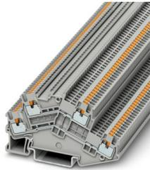
Morsetto a due piani, tensione nominale: 500 V, corrente nominale: 16 A, tipo di connessione: Connessione Push-in, 1. e 2. piano, Sezione di dimensionamento: 1,5 mm<sup>2</sup>, sezione: 0,14 mm<sup>2</sup> - 1,5 mm<sup>2</sup>, tipo di montaggio: NS 35/7,5, NS 35/15, colore: grigio
