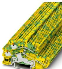
Morsetto a due piani per conduttori di terra, tipo di connessione: Push-in / attacco connettore, 1. e 2. piano, sezione: 0,14 mm<sup>2</sup> - 1,5 mm<sup>2</sup>, tipo di montaggio: NS 35/7,5, NS 35/15, colore: giallo-verde
