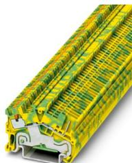
Morsetti comp. per conduttori terra, numero di connessioni: 2, numero poli: 1, tipo di connessione: Push-in / attacco connettore, 1. piano, sezione: 0,14 mm<sup>2</sup> - 1,5 mm<sup>2</sup>, tipo di montaggio: NS 35/7,5, NS 35/15, colore: giallo-verde
