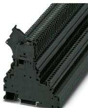
Morsetto portafusibili, tipo di fusibile: Vetro / ceramica / ..., tipo fusibile: G / 5 x 20, tensione nominale: 24 V, Corrente continua termica  $I_{th}$ : 28 A, tipo di connessione: Connessione a vite, Sezione di dimensionamento: 4 mm<sup>2</sup>, sezione: 0,14 mm<sup>2</sup>- 6 mm<sup>2</sup>, tipo di connessione: Connessione a vite, Sezione di dimensionamento: 4 mm<sup>2</sup>, sezione: 0,14 mm<sup>2</sup>- 6 mm<sup>2</sup>, tipo di montaggio: NS 35/7,5, NS 35/15, colore: nero
