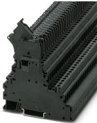
Morsetto portafusibili, tipo di fusibile: Vetro / ceramica / ..., tipo fusibile: G / 5 x 20, tensione nominale: 250 V, Corrente continua termica  $I_{th}$ : 28 A, tipo di connessione: Connessione a vite, Sezione di dimensionamento: 4 mm<sup>2</sup>, sezione: 0,14 mm<sup>2</sup>- 6 mm<sup>2</sup>, tipo di connessione: Connessione a vite, Sezione di dimensionamento: 4 mm<sup>2</sup>, sezione: 0,14 mm<sup>2</sup>- 6 mm<sup>2</sup>, tipo di montaggio: NS 35/7,5, NS 35/15, colore: nero
